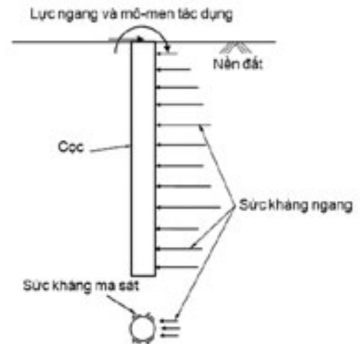
Hình 3. Cơ chế truyền tải trọng của cọc chịu tải trọng ngang
